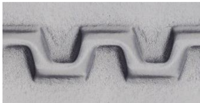
TR30製金型で成形した ガラス製マイクロ流路チップ
